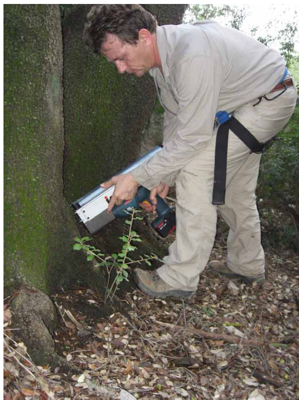
SONDAGE D'UN ARBRE AU RÉSISTOGAPHE - © D.R.
