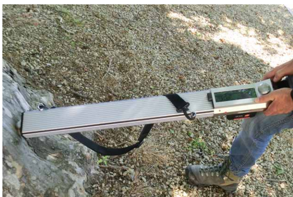
LES PÉNÉTROMÈTRES PERMETTENT DE DÉTECTER LA PRÉSENCE DE CAVITÉS INTERNES ET DE MESURER L'ÉPAISSEUR DE BOIS SAIN RESTANT AUTOUR - © D.R.
