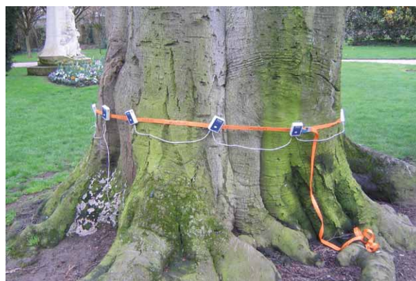
MISE EN PLACE D'UN TOMOGRAPHE (SYSTÈME PICUS®) AVEC SES DIFFÉRENTS CAPTEURS POUR CARTOGRAPHIER LA POURRITURE INTERNE - © D.R.
